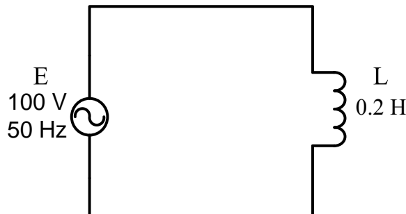
รูปที่ 3.2 วงจรขดลวดเหนี่ยวนำ ตัวอย่างที่ 3-3
