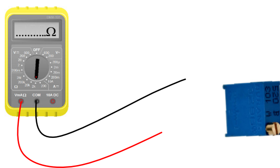
รูปที่ 9.20 วัดค่าความต้านทานของตัวต้านทานปรับค่าได้ R_4
